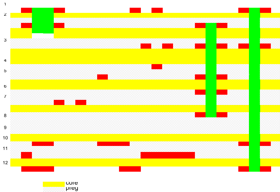
MC 12C, 2 passages, 3 perçages dont 1 borgne limité en axe Z
